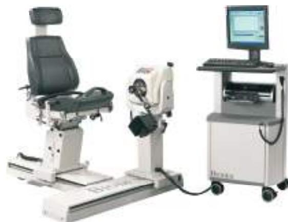
Роботизированный комплекс предназначен для диагностики и лечения суставно-мышечной патологии. Позволяет проводить мобилизацию суставов в направлении сгибание/разгибание, отведение/приведение и ротация. Принцип действия основан на электронной динамометрии с измерением вращающего момента, скорости и положения.
